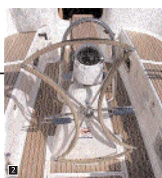
2. La ruota sacrificata sempre il passaggio all'interno del pozzetto. All'ancora, il modello pieghevole della foto potrebbe risolvere il problema. Ma quegli angoli vivi sono indubbiamente pericolosi.
