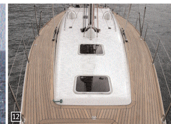
11. Ecco una posizione ergonomica per il timoniere: paramare ribassato per una seduta comoda, giusto appoggio della schiena sulle draglie, puntapiedi efficace. 12. Passavanti ampi e liberi da intralci, fianchi verticali della tuga su cui puntarsi in bolina: un ottimo disegno.
