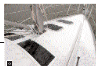
6. I vetri frontali sono senz'altro utili per la luminosità degli interni, non altrettanto per la completa agibilità della tuga.
