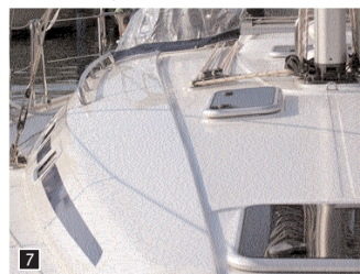
7. A questa tuga manca del tutto l'antisdrucchio proprio dove è più necessario. Ovvero nelle zone laterali.
